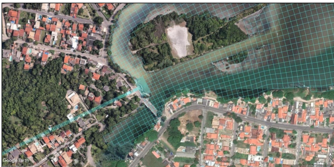
Figura 17: Vista em planta da grade de cálculo do modelo Delft3D-FLOW na conexão do Túnel do Tibau com a Lagoa de Piratininga.
