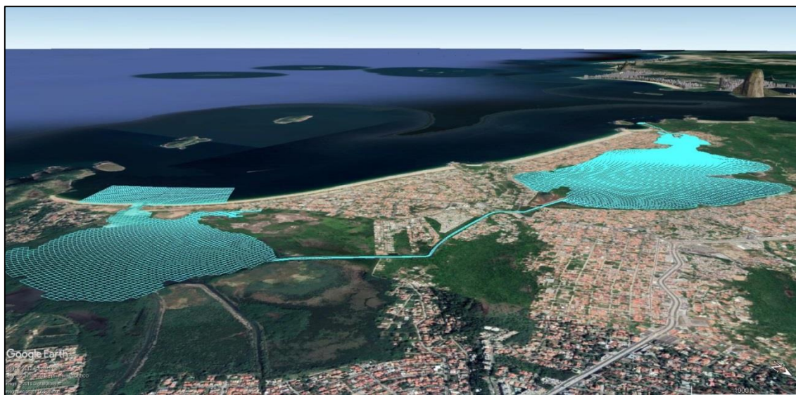
Figura 9: Vista geral em perspectiva das grades de cálculo do modelo Delft3D-FLOW implementadas para o Complexo Lagunar Itaipu-Piratininga, em Niterói.
