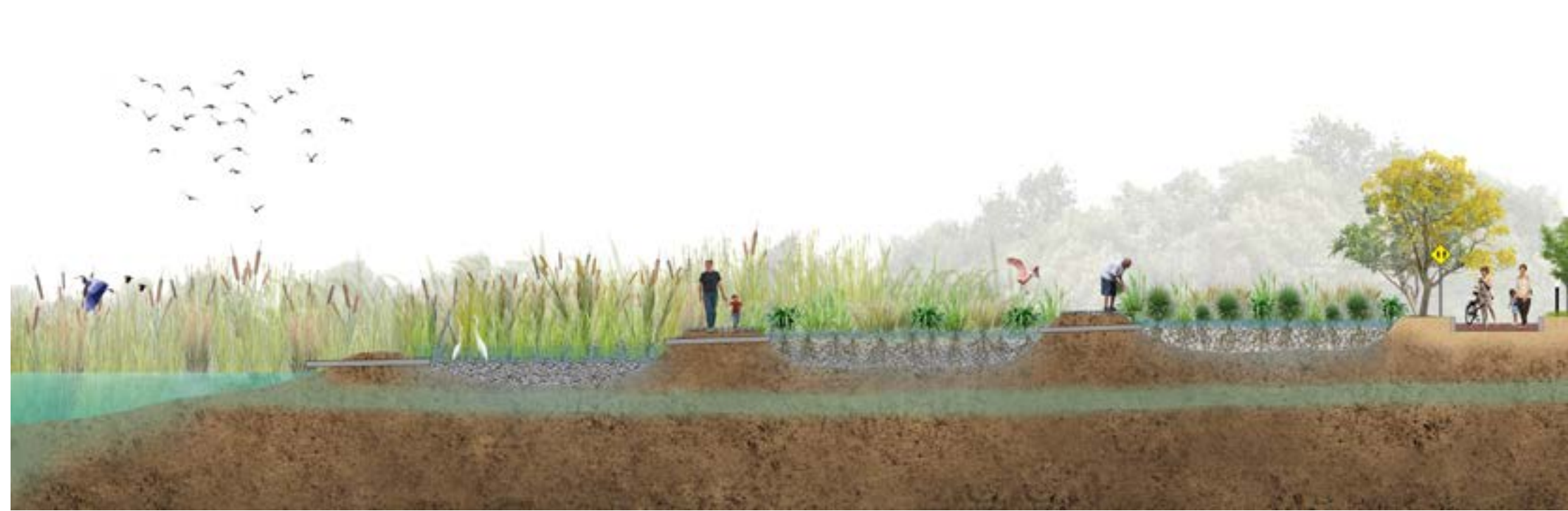
Jardins de comodação e filtragem das águas pluviais
